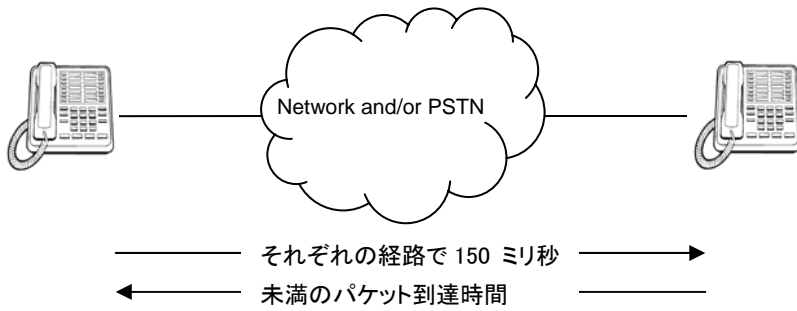
図 1. 許容できる QoS を実現するためには音声エンコード・デコード時間を含め、packet 到達時間は 150 ミリ秒未満でなければならない
