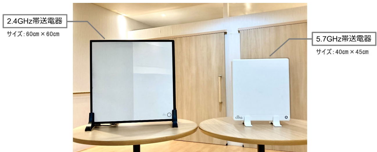
より小さなサイズを実現した5.7GHz帯Cota送電器（右）
