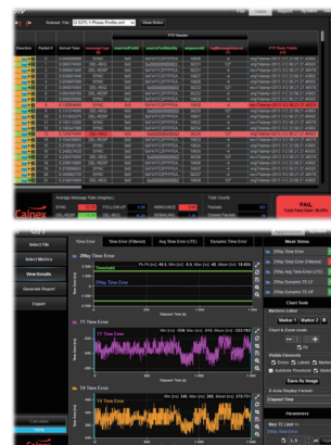
【図 3】 Calnex 社のタイムエラー測定器 Paragon-Neo と、測定結果を可視化した画面
