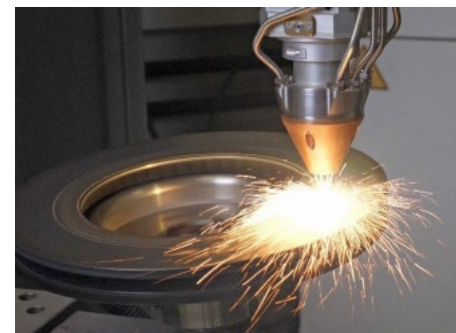
▲ブレーキディスクへのハイスピードレーザクラッディング
