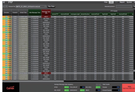
■図2:ネットワークの各地点でトラブルシューティングができるCalnex製時間遅延監視ツール「Sentinel」
