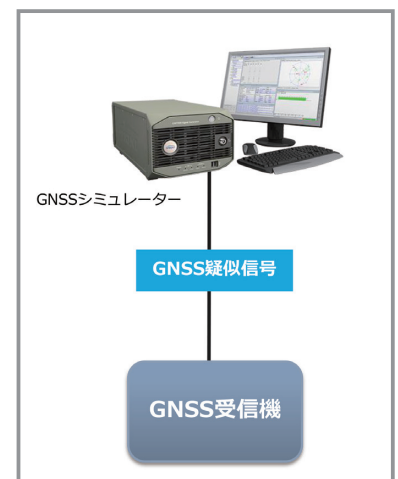
■図4:Spirent製GNSSシミュレータ「GSS7000」による事前試験
