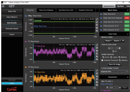
Calnex製PTP解析ツール「Paragon-Neo」の測定画面
