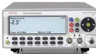
図 1: 位相値、周波数、減衰 Va/Vb、および補助パラメータを表示したディスプレイ。
