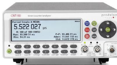
図 4: 異なる統計パラメータを同時に表示したディスプレイ。
