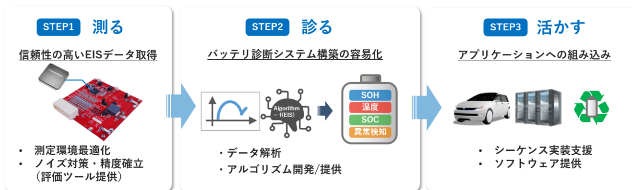
バッテリー診断ソリューション開発フローとサポート
