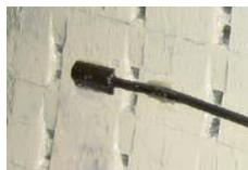
アイリス・パワー社の TFProbe™は、主に水力発電機、その他の突極機のために設計されています。このプローブはまた、エアギャップの大きさが 50mm 未満の円形ローター機械においても使用することができます。
