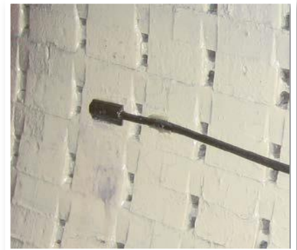
タービン発電機のステータ歯に接着されたアイリス・パワー社 TFPProbe
