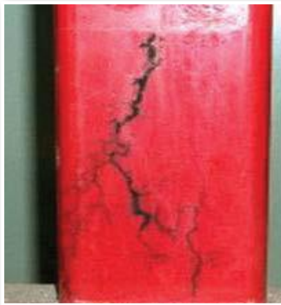
汚染に起因する高電圧母線の電氣的なトラッキング
