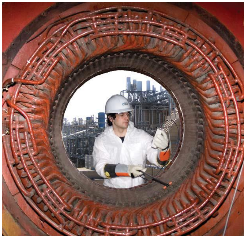
アイリス・パワー社のコロナプローブモデル PPM-97 をモータ固定子における部分放電の部位を見つけるために使用。
