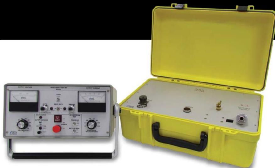
IRIS 社の DCR 60-2 は、予期しない使用中の故障が起きる前に大型交流機の固定子の主絶縁システムの問題を特定するための簡単なオフライン DC 試験機です。DC または AC ハイポット試験での良否とは異なり、DC ランプ試験は診断情報が得られ、故障が起きる前に停止することができます。
