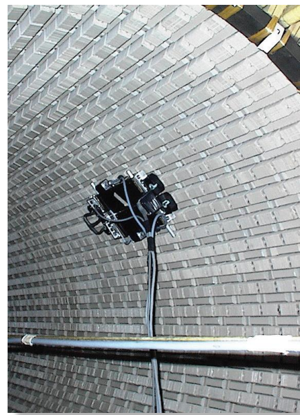
ターボジェネレータ上で進行中のロボットのテスト (ロボット式検査台車(RIV)機能はオプションです)
