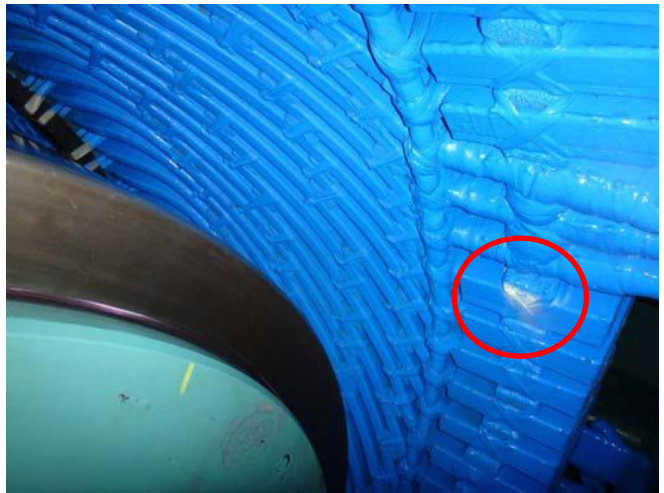
図 1 - フェルトブロックとステータエンドキャップ間での発塵
