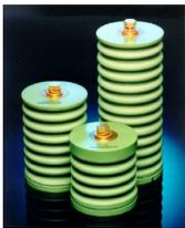
上記のいずれの場合も部分放電センサーであるバス・カプラー(右図参照)を恒常的に設置します。バス・カプラーは部分放電の周波数帯域(50MHz~250MHz)で動作する一種の80pFのコンデンサーです。この高電圧用キャパシターは測定に必要な部分放電信号を取り出すハイパスフィルターになります。アイリス社は既にこのセンサーを世界中に25,000個以上も販売しています。これまで一個も不具合を起こしておりません。実際、IEEEはこの寿命を理論上60,000年としています。そのころまでには我々は全員引退していますが...
