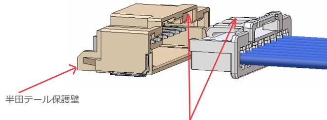
アウターポジティブロックに比べ、DuraClikのインナーポジティブロックは、省スペースを実現し、組み立て時のワイヤーのもつれによってラッチが破損するのを防ぎます。
