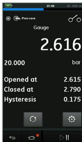
**Pressure leak test (圧力リークテスト)**：漏れを検出し、リーク率を判定するための自動化された手順です。整定および実行時間は、プログラミング可能です。開始圧力と停止圧力が圧力変化およびリーク率とともに報告されます。
