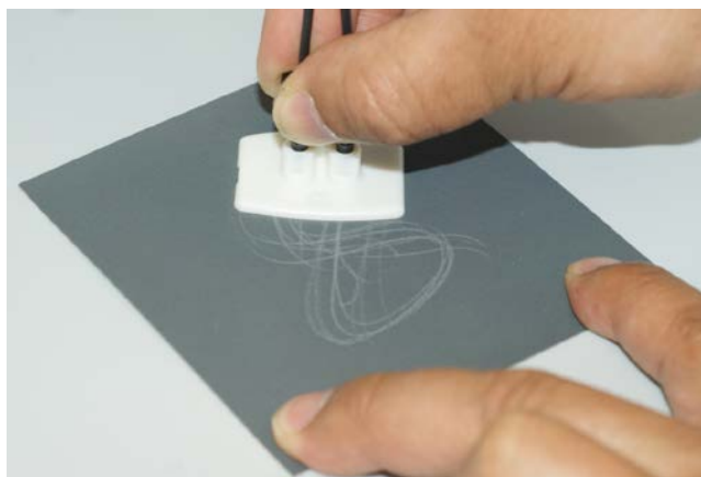
図27. 研磨紙上で8字形パターンで研磨
