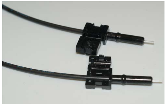
図24. クリンプレス・デュプレックス・コネクタの準備
