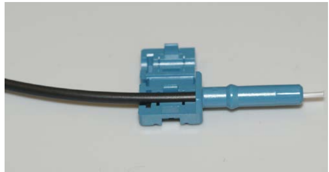
図23. シングルプレックス・クリンプレス・コネクタを使用したPOFケーブル終端
