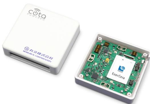
【Cota Enabled IoT Sensor】
