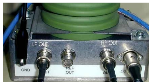
ポータブル・カプラーの接続
