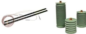
エポキシマイカコンデンサ（EMC）およびステータスロットカバー（SSC）は、モーターおよび発電機のステータ巻線内で発生する部分放電（PD）を検出するために使用される高周波センサーです。取り付けるPDセンサーの数は、マシンのタイプとサイズによって異なり、マシンごとに3から24センサーまで異なります。
