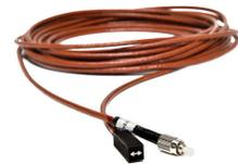
巻線端振動センサーは、発電機の固定子の巻線端の振動を測定するために使用される非金属製の光ファイバー加速度計です。センサーは、空冷式発電機と水素冷却式発電機で見られる高電圧および磁場で、半径方向および接線方向の振動を同時に安全に測定できます。
