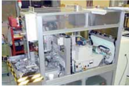
シール材塗布・硬化装置
