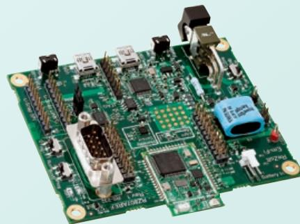
ReZolt社製 無線LANモジュール用評価ボード
