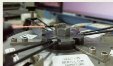
加速度センサの校正作業の様子
