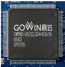
〈ゴーウィン社製FPGA “LittleBee GW1NS”〉
